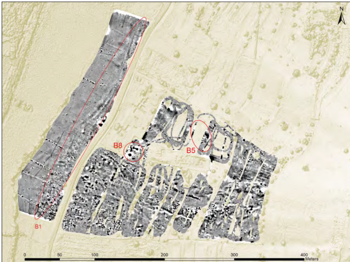
12 Magnetogramm 254 Graustufen (weiß: -4nT ; schwarz: 6nT ) im Untersuchungsareal 2017
