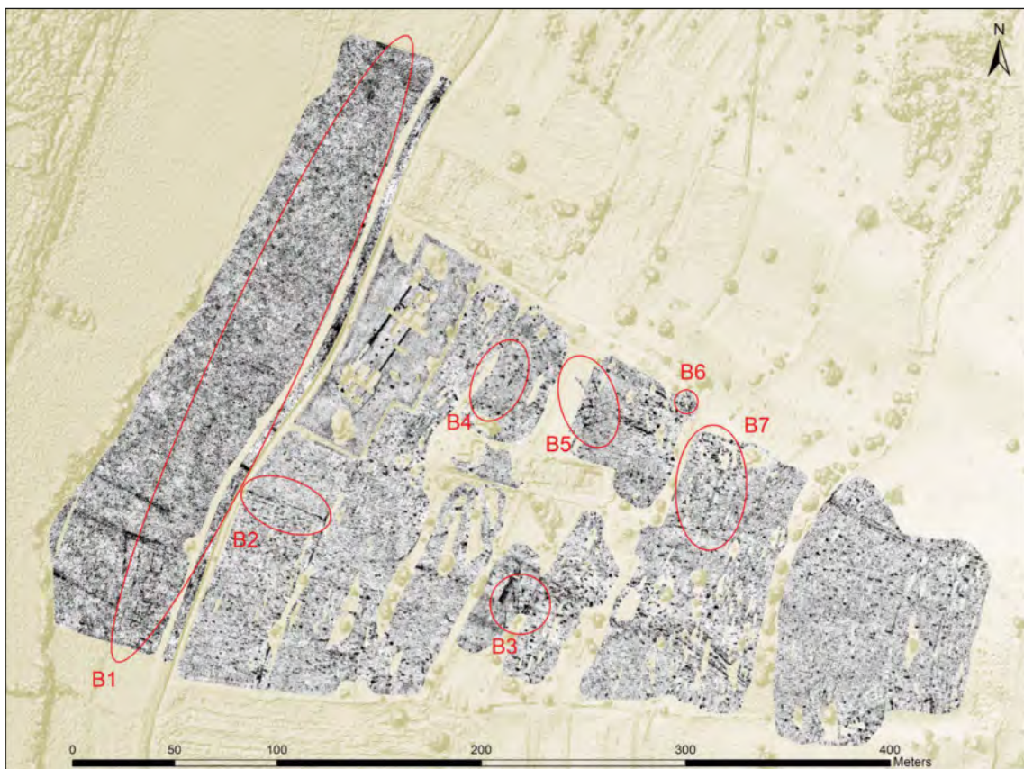
13 Akkumulierte GPR-Tiefenscheibe, ca. 50–100 cm Tiefe im Untersuchungsareal 2017
