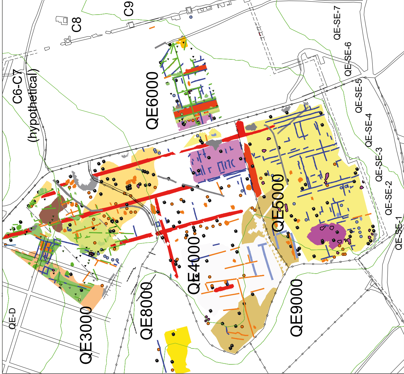
6 Interpretierende Umzeichnung der Magnetometer- und der Bodenradarprospektion in den Zonen QE 3000–QE 8000
