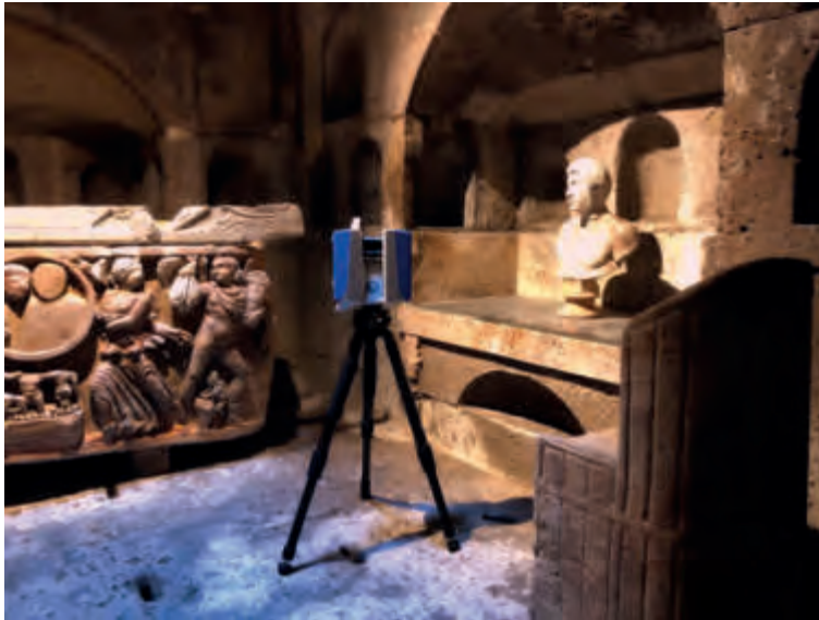
6 Mit dem terrestrischen Laserscanner wurden die Grabkammer, der Schutzbau, das Wärterhaus sowie das Umfeld dreidimensional vermessen. Insgesamt 51 Standorte wurden für die maßstabsgerechte Erfassung der Architektur benötigt (Foto S. Geiermann scandric 3D Solutions)
