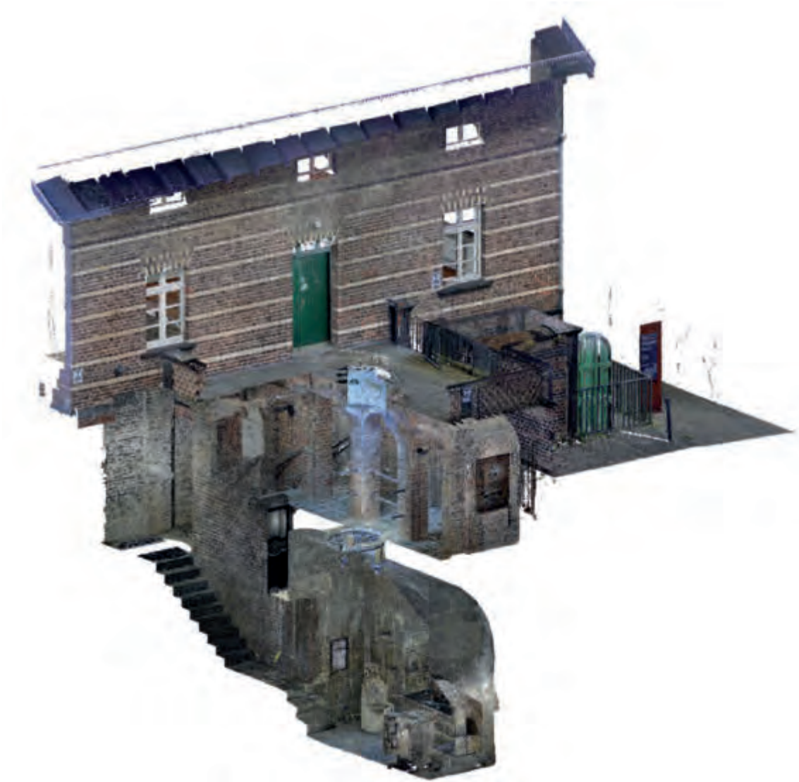
3 Schnitt durch die Punktwolke: unten das Hypogaeum, darüber der Zwirner'sche Schutzbau und im Hintergrund das Chaussee-Aufseher-Häuschen (Grafik S. Geiermann scandric 3D Solutions)
